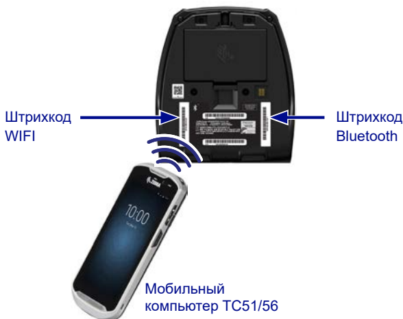
Рис. 23 • Подключения по каналам BT/WLAN
